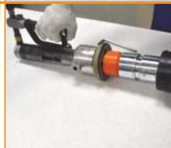
**9** Учитывая свойства материала напорной трубы по возврату в первоначальное состояние, после извлечения расширительной насадки незамедлительно вставить тройник до упора в расширенную часть напорной трубы ИЗОЛА.ПРО.
