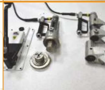
**11** Смазать торец напорной трубы техническим вазелином или жидким силиконом, произвести запрессовку гильзы до упора с монтажным кольцом (или буртиком тройника, если Тип 2).
