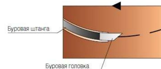
Рисунок 10.9. 1 этап горизонтального направленного бурения
