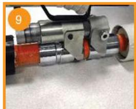
**ВНИМАНИЕ!** Перед началом монтажа пресс-муфты необходимо надеть термоусадочную муфту на поверхность трубы ИЗОЛА.ПРО, предварительно поверхность трубы предварительно очищается от загрязнения!
