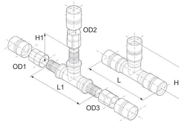
Рисунок 4.6. Пресс-тройник с полимерной втулкой
