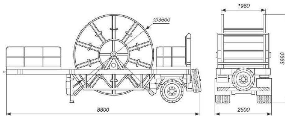
Рисунок 12.4. Габаритные размеры полуприцепов специальных (ППС-52 и ППС-102)
