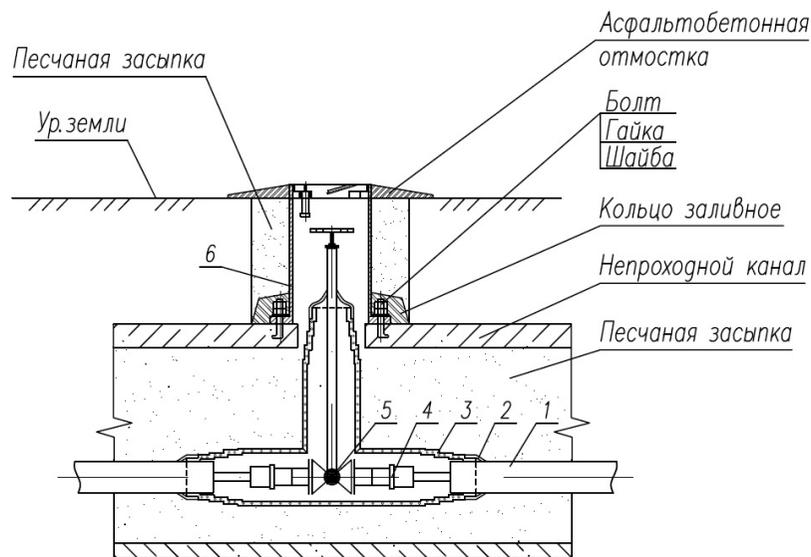
Рисунок 10.25. Узел установки запорной арматуры при внекамерной врезке
