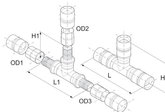
Рисунок 6.8. Пресс-тройник с полимерной втулкой
