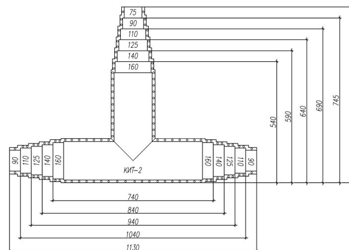
Рисунок 7.3. Размеры кожуха комплекта КИТ-2
