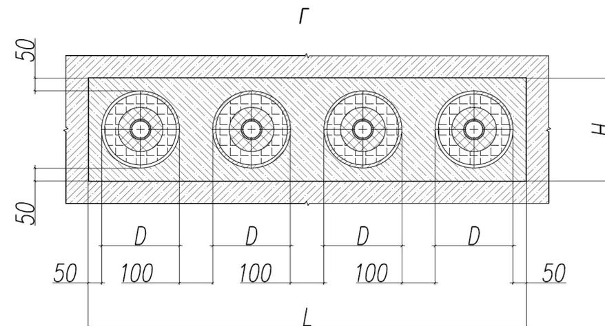
**Рисунок 10.17. Размеры отверстий при пробивке стены**
