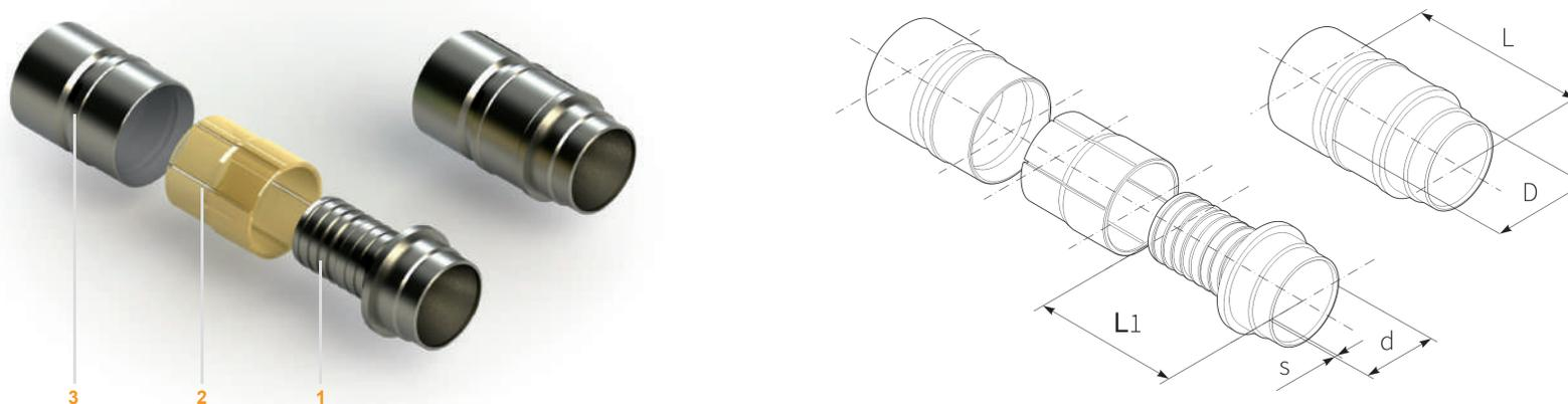
Рисунок 6.4. Пресс-фитинг концевой с полимерной втулкой под сварку
