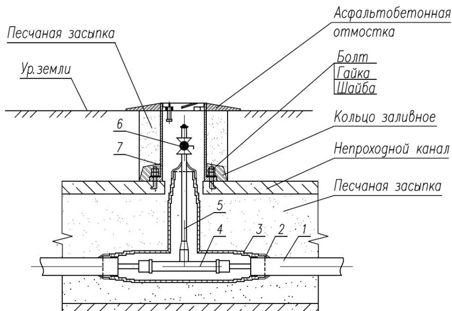
Рисунок 10.24. Узел установки шарового крана для выпуска воздуха при внекамерной врезке
